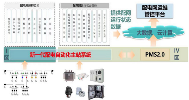
图2 供电企业配电网运维管控平台
