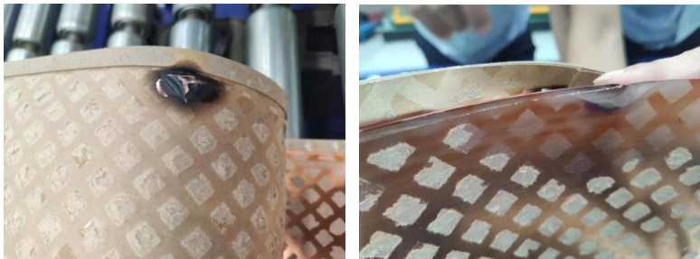
图 1 低压线圈故障点
