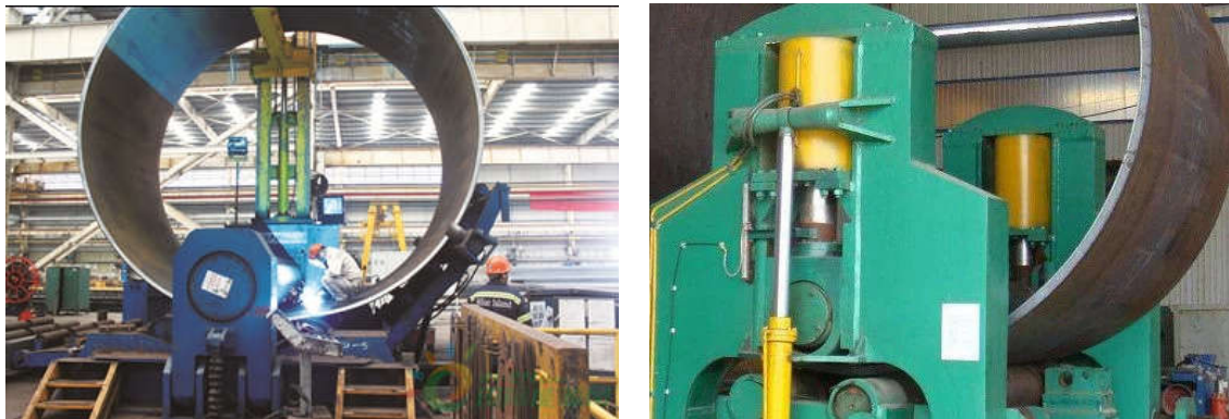
图1 卷板机卷圆成型工艺
