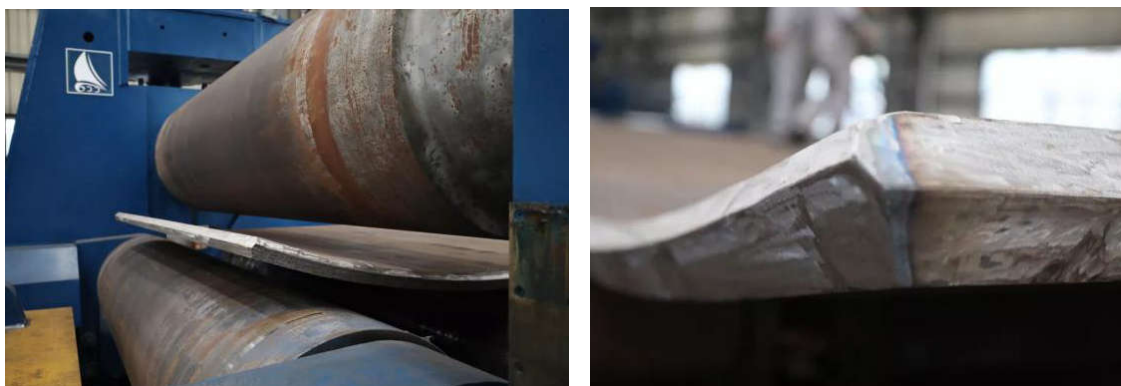
图2 筒体对接焊接预制坡口类型
