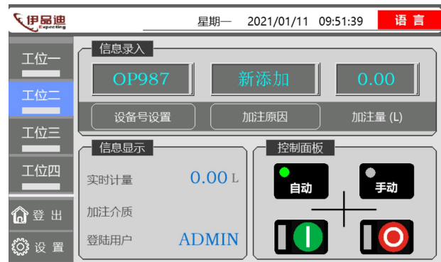
图 1 卡修车间油品加注系统智能加注人机界面
