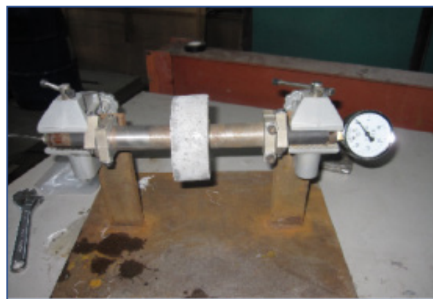
图2 碳化试件保护层开裂模拟试验
