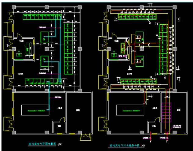
图2 变电室平面布置图
