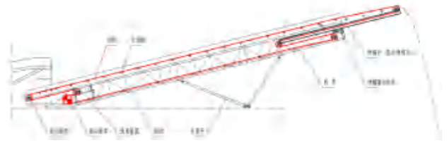
图 4 伸缩式皮带装船机主要结构图
