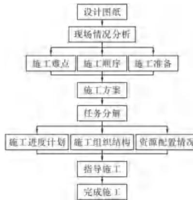
图1 地铁施工流程
