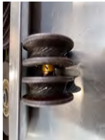
图 1 滑轮出现明显压痕
