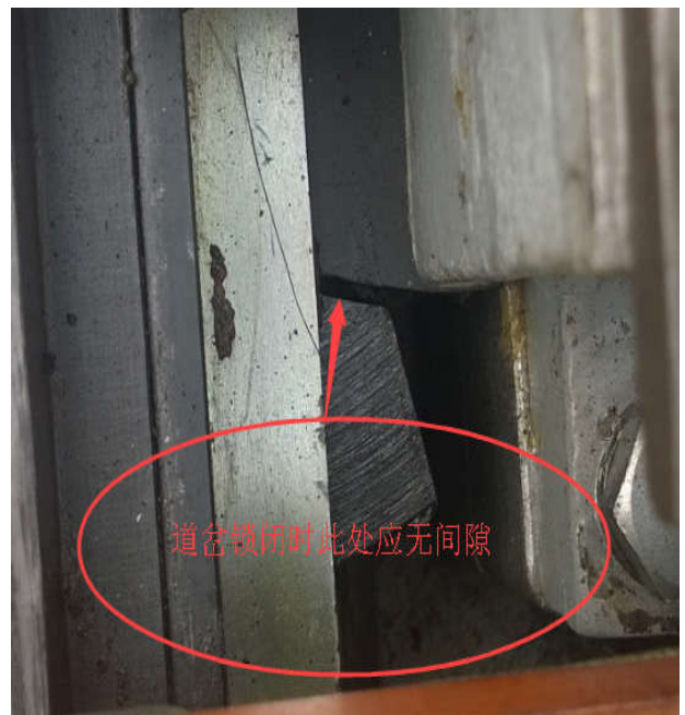
图8 机内锁铁与锁块
