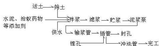
图2 劈裂灌浆防渗施工流程
