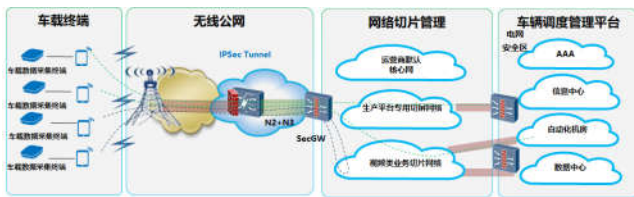
图示 2: 5G 智慧煤矿网络结构图
