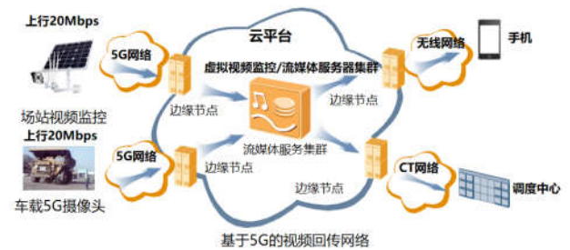
图示 3: 5G 智慧煤矿视频回传网络结构图
