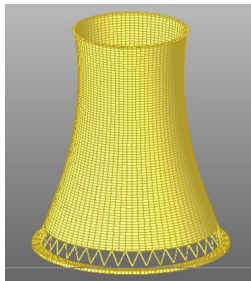
图 1 双曲线自然通风冷却塔外壳立面图
