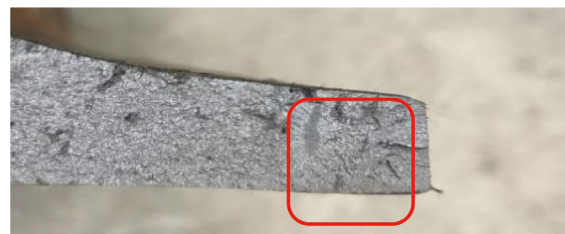
图 1 接头断后及灰斑形态
