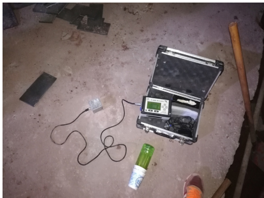
图 3 爆破振动现场监测
