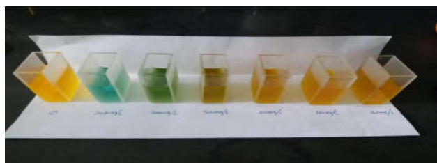
图2 不同的溶液颜色对应的COD浓度
