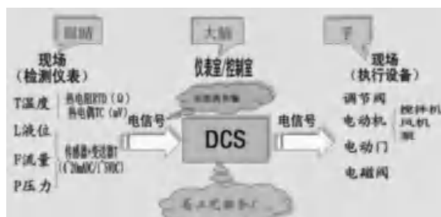
图1 DSC系统示意图
