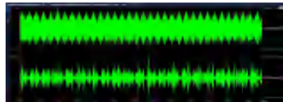
图11 精轧机开卷机 / 传动侧锥头轴承输出 7/128k 加速度波形 (0.1-2000) 时域波形
