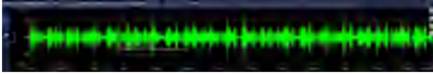
图6 精轧机开卷机 / 传动侧锥头轴承输出 7/128k 加速度波形 (0.1-2000) 时域波形
