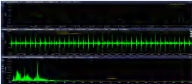
图2 精轧机开卷机 / 传动侧锥头轴承输出 7/128k 加速度趋势 - 波形 - 频谱 (0.1-2000) _ 趋势分析
