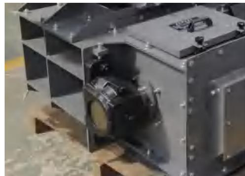
图 5 埋刮板输送机轴密封结构示意图及实物照片
