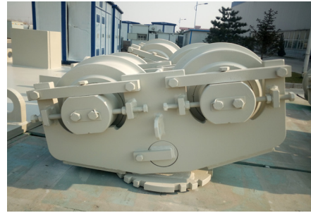
图 3 直流变压器小车总装配
