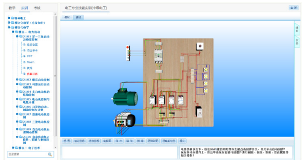
图3 实训——星-三角启动顺序控制的导线装接
