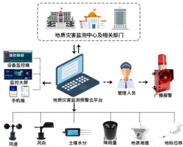
图 1 历史遗留矿山滑坡地质灾害监测流程
