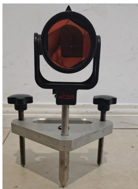
图 5 无砟轨道精调基准网 (TARN) 测点对中标架
