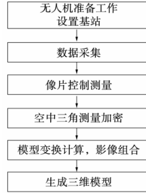
图 2 无人机遥感三维建模工作流程
