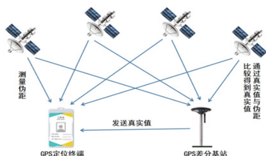
图 1 GPS 差分定位原理
