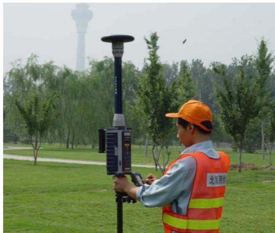
图1 网络RTK数据的应用实拍图
