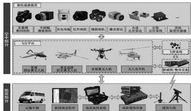
图 1 无人机遥感测绘技术系统组成图
