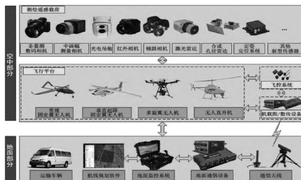
图 1 无人机遥感测绘技术系统组成图
