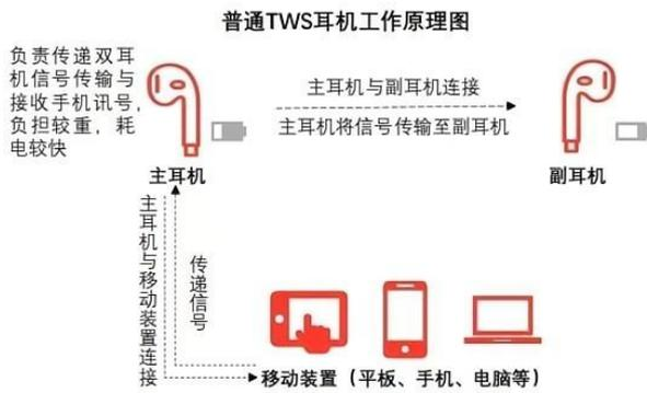
图1 TWS蓝牙耳机工作原理图
