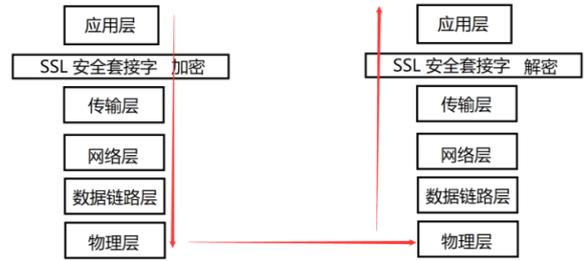
图2 数据加密技术流程图
