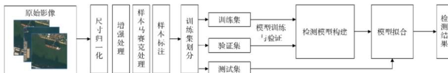
图 8 基于 Att-DConv 的识别方法完整技术流程图
