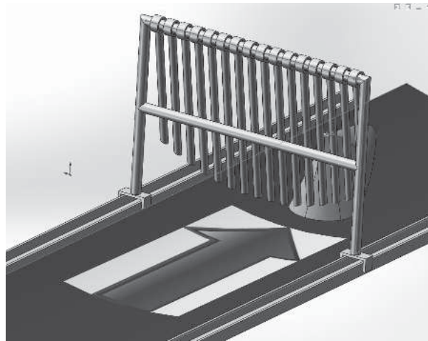
图2 煤矿井下皮带挡矸装置工作原理示意图
