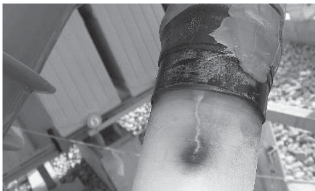
图2 110kV某变电站电缆终端解剖图
