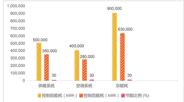
图2 暖通系统控制策略实施前后能耗对比
