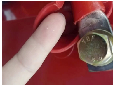
图 1 绝缘胶套内有金属碎屑
