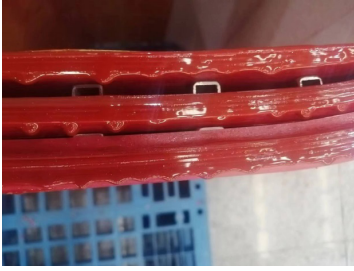
图4 端部有较多水滴状树脂
