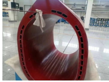
图6 清理后的高压线圈
