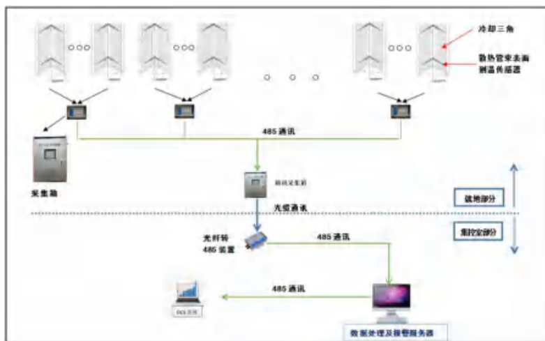
图1 直接空冷机组冷端优化，温度监测择优智能控制
