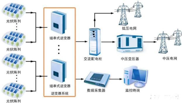
图1 光伏电站主要设备构成图
