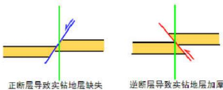
图 3 正、逆断层在地层接触关系上的区别
