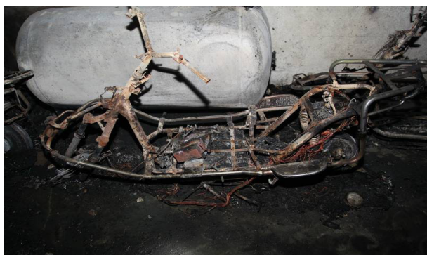
图8 2号电动自行车烧损情况
