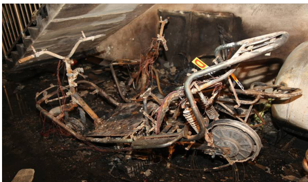
图7 4号电动自行车烧损情况
