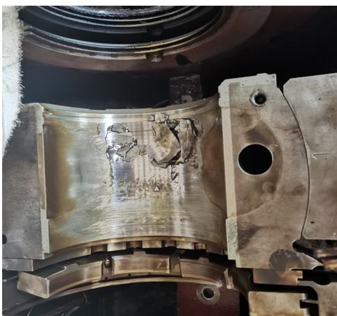
图2 轴瓦磨损
