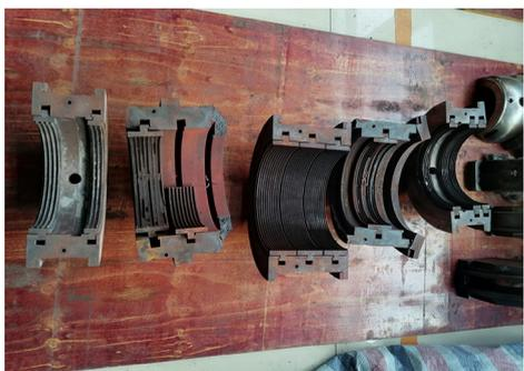
图3 轴瓦磨损拆解
