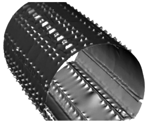
图 1 地面三维激光扫描技术对地铁隧道变形测量应用效果图
