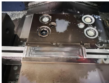
图3 (虎钳夹持加工台阶)
