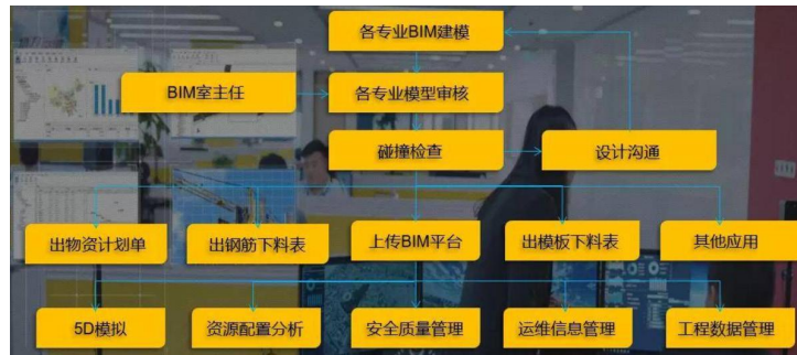
图 2 BIM 技术应用路径
