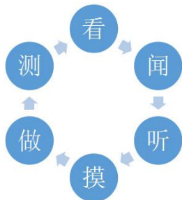
图2 船舶电气设备的维修检测方法
