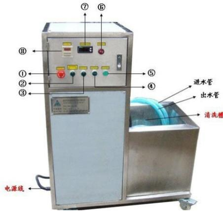
图2 化学清洗槽
