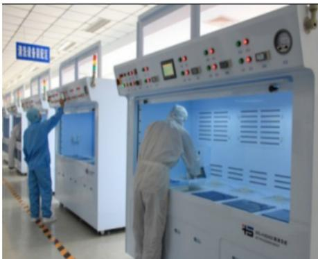
图 1 工作人员对硅片进行清洗工作
