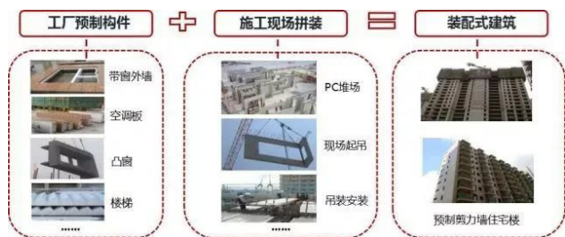
图 1 装配式建筑施工流程示意图
