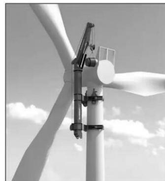
图7 风电维修起重机
