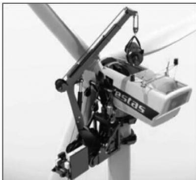
图3 维斯塔斯维修起重机
