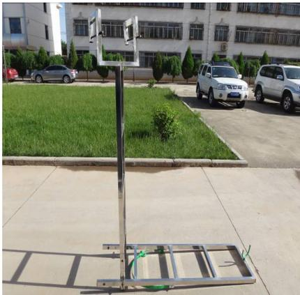
图7 旋转折叠硬梯实物
