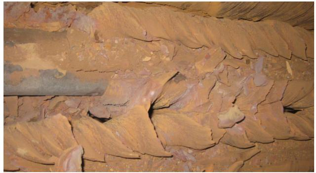
图1 再热器管壁结焦实拍
