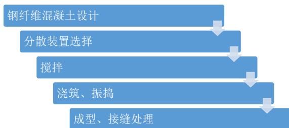
图 2 钢纤维混凝土在公路工程项目中的应用
