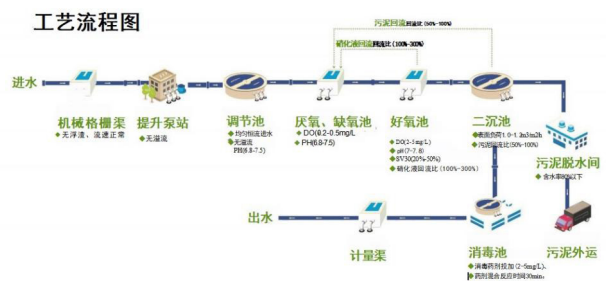
图 1 A 2 O 污水处理工艺
